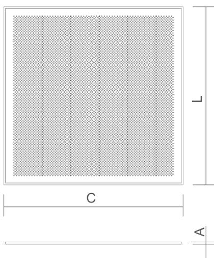
Sistema de forro metálico em alumínio puro modelo bandeja rebaixado, instalados em perfis modelo T15 invertido em aço galvanizado.
