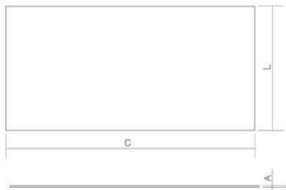
Com 7 mm de espessura e dimensões de 617 x 617 mm e 1243 x 617 mm, as placas são leves, encaixam-se perfeitamente nas modulações de forro Ingermann e são removíveis, tornando fácil sua instalação e manutenção.
